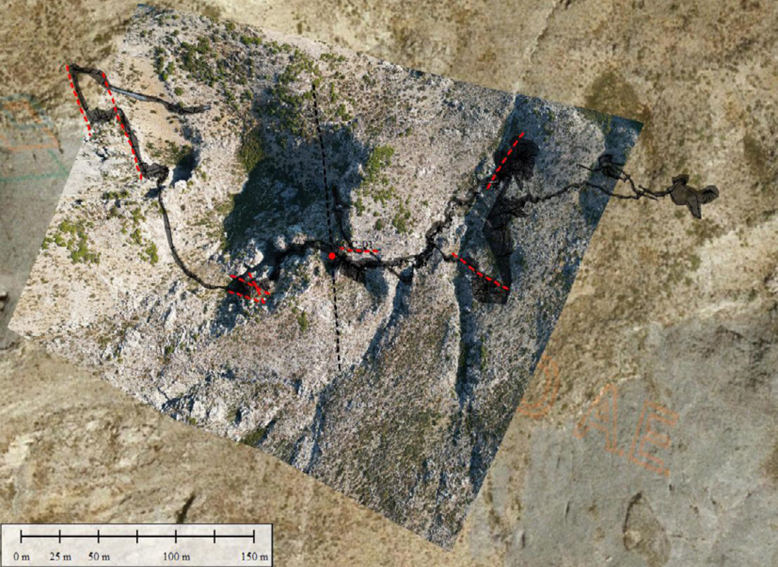
Ορθοφωτοχάρτης με τη σκιαγράφιση του σπηλαιίου Γουργούθακας και σημειωμένες τις κύριες τεκτονικές ασυνέχειες που σημειώθηκαν εξωτερικά (μαύρο) και εσωτερικά του σπηλαιίου (κόκκινο).
